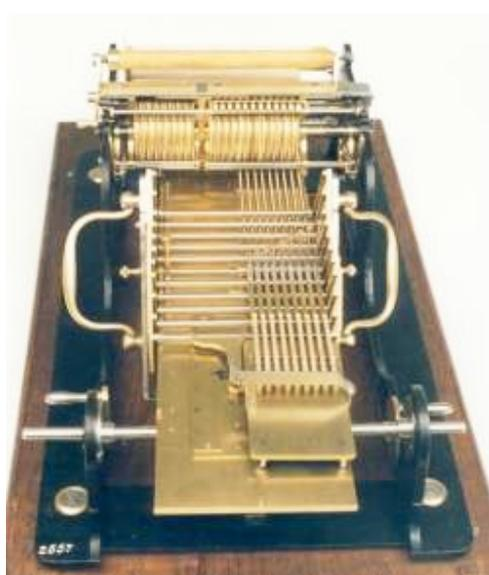
Bild 7: Sellings Multipliziermaschine erste Bauart für positive und negative Ziffern
