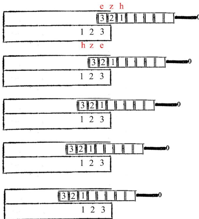
Bild 4: Die Berechnung von  $123 \times 123$  auf dem Multipliziergerät von Seidel
