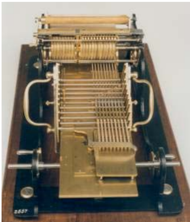
Bild 3: Prototyp der Multipliziermaschine erster Bauart im Deutschen Museum München
